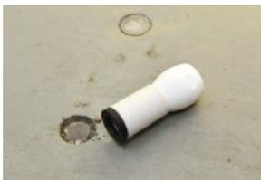
リフトをしっかり支えるのは10cmほど施工時に埋め込んだセラミック製のアンカー。このアンカーにリフト支柱を固定して使用する。リフトの支柱がないことで普段はフロアスペースをフルに有効活用。
